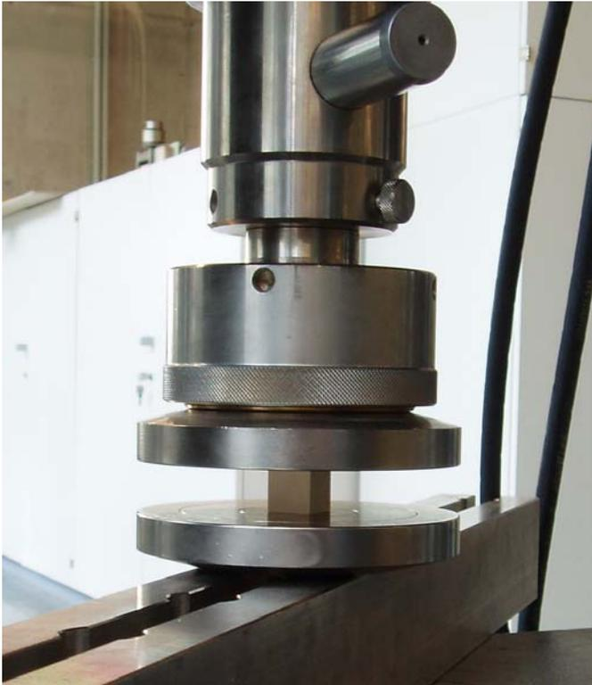
**Abb. 10:** Druckprüfung
