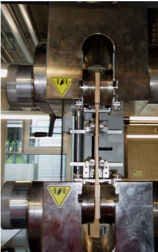
**Abb. 5:** Zugprüfmaschine
